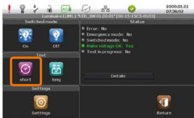
Bild 54. Start av korttidstest av armatur från adressmodulmenyn.
