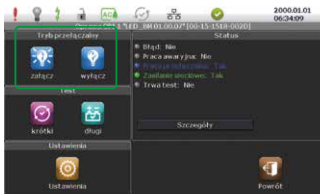
Bild 60. Aktivering/deaktivering av nattbelysning för enskild armatur från adressmodulmenyn
